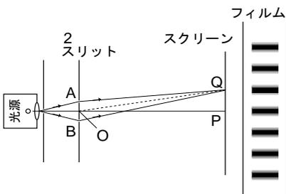
図 7.3: ヤングの実験. 作図の都合上、図の縦方向は横方向に比べて拡大してある。またフィルム上の明暗の縞模様は別の尺度で描かれている。
